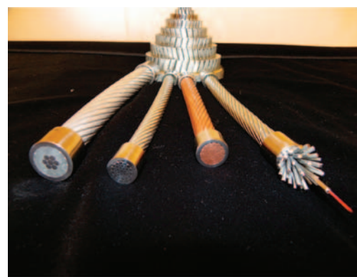
Рис. 2: а) разрез несущих тросов круглой и компактированной формы; б) внешний вид тросов.
